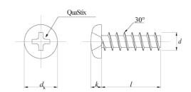
QuaStix (クオスティックス) 穴は、トルク伝達力に優れ、カムアウトしにくい十字形の駆動部です。通常のH形十字穴用の工具も使用できますが、専用工具を用意しています。
