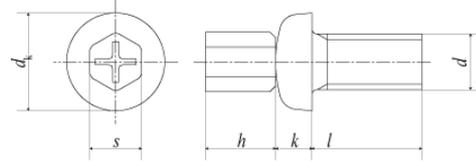
締め付けると六角部が破断し、リセスのない頭部が露出
