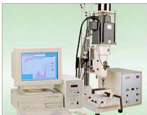
PCトルクアナライザー試験機 サーボモータータイプ
