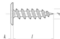
QuaStix (クオスティックス) 穴は、トルク伝達力に優れ、カムアウトしにくい十字形の駆動部です。通常の H 形十字穴用の工具も使用できますが、専用工具を用意しています。
